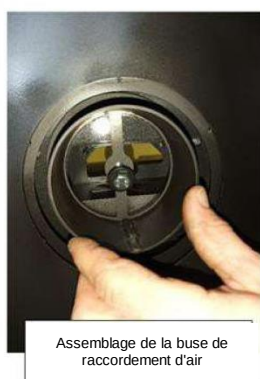
Fixation de la buse de raccordement d'air à l'aide d'une vis
