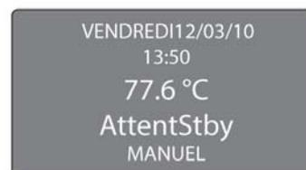
C'est seulement lorsque la température de l'eau redescend en dessous de celle définie de -1°C et que l'appareil a terminé son cycle d'extinction qu'il se rallume en passant à l'état de fonctionnement [Redémarr.].
