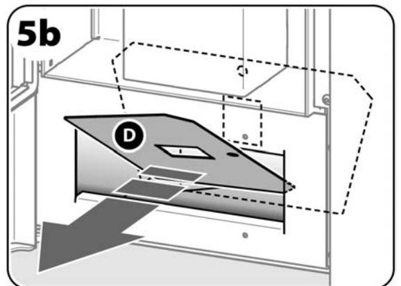
6. Vider le compartiment à l'aide d'une petite pelle, puis aspirer la suie et les cendres restées à l'intérieur du compartiment de collecte des poussières de l'échangeur.
