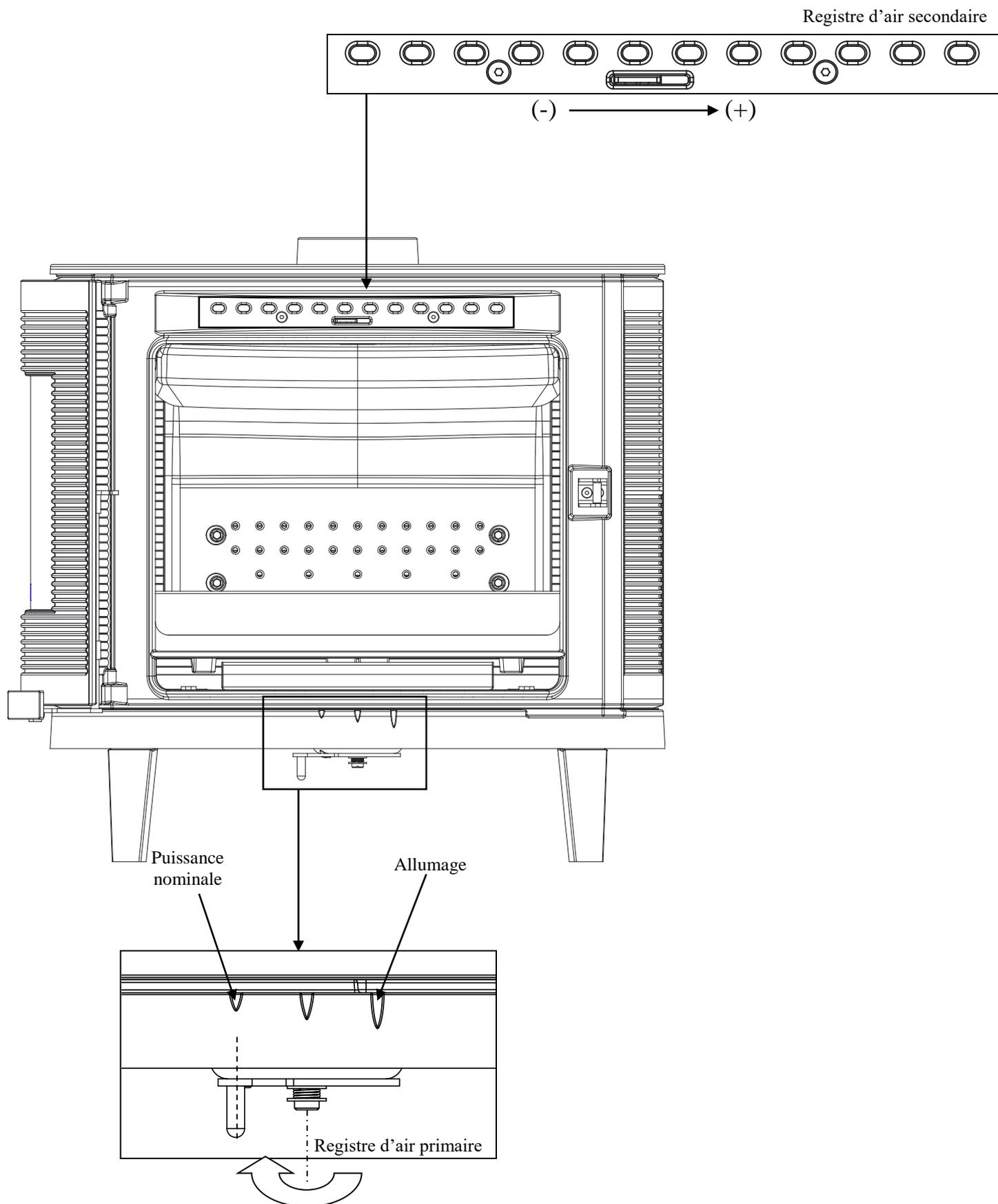
La position « Combustion prolongée » est obtenue en tournant complètement le registre de réglage vers la gauche.
