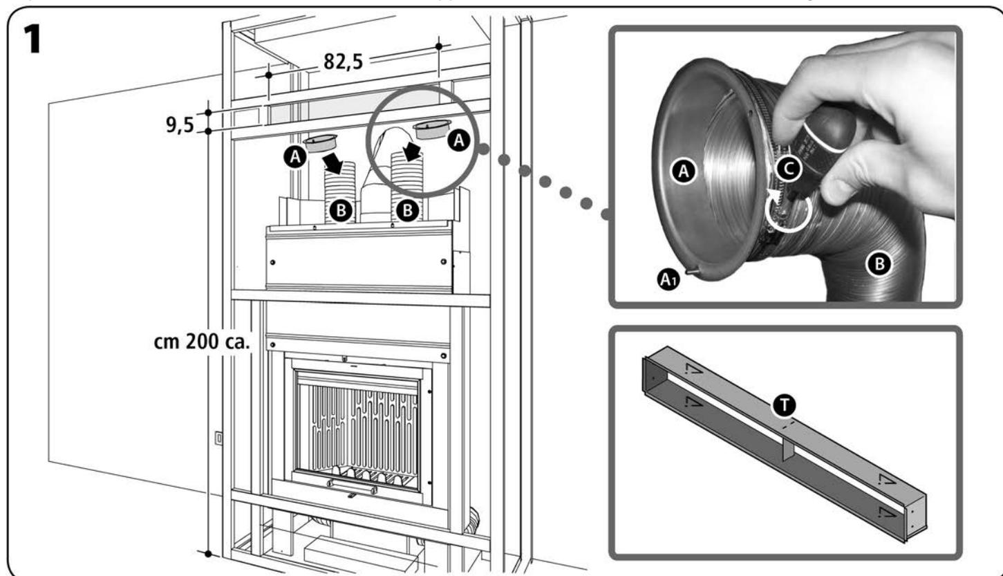
**i** Réaliser une ouverture identique au cas où une trémie longue naturelle serait installée et la fixer à la structure métallique tel qu'indiqué au point 2.
