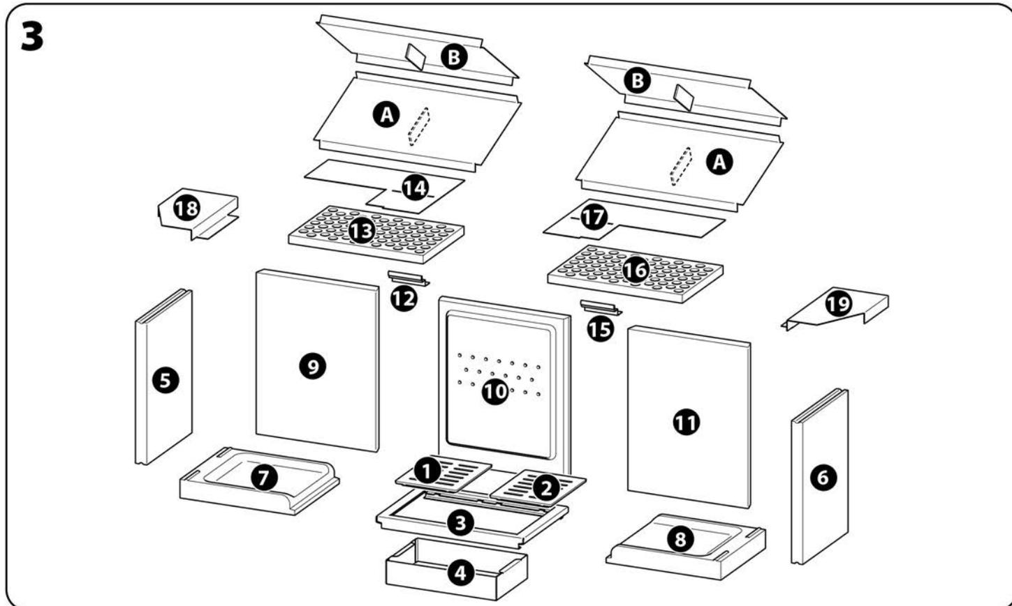
Pour exécuter les travaux de nettoyage, il faudra enlever quelques éléments intérieurs de la chambre de combustion; prendre garde de manipuler les éléments du parement en CMtech® avec beaucoup de soin et suivre l'ordre numérique (voir figure 3).
