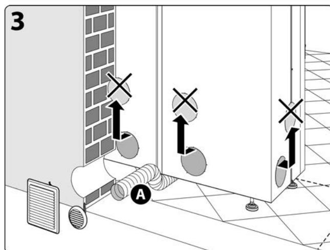
aluminium et le fixer avec un collier de serrage, puis introduire la section dans le trou réalisé au préalable; monter les 2 grilles en PVC, l'une sur le tuyau flexible de Ø 8 cm et l'autre sur le trou de Ø 15 cm.
