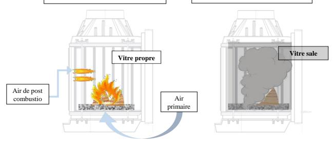
Schéma de « principe » non représentatif de l'appareil
