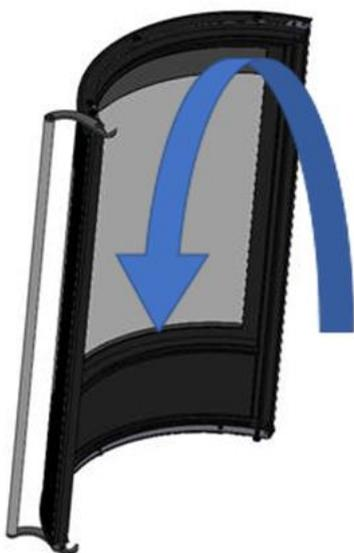
**Note :** Si nous utilisons l'appareil dans des conditions de tirage supérieures à 15Pa ou si nous brûlons plus de bois (par heure) que celles indiquées dans le tableau 1.1, nous soumettons l'appareil à des conditions de travail supérieures à celles pour lesquelles il a été conçu. Cela peut entraîner un encrassement agressif du verre (halo blanc), qui ne peut être nettoyé par la méthode traditionnelle.
