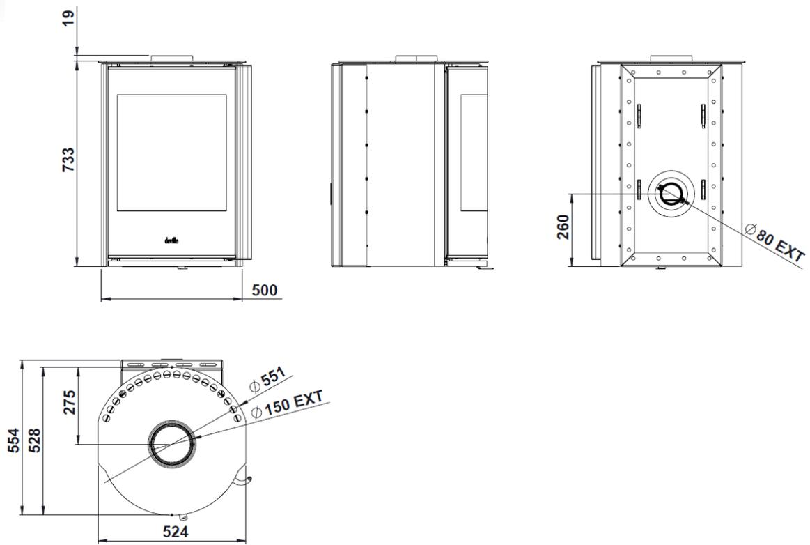
Figure n°2 - Dimensions en mm de l'appareil EGUZKI MURAL
