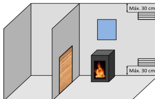
Figure n°5 - Schéma indicatif pour les grilles de ventilation
