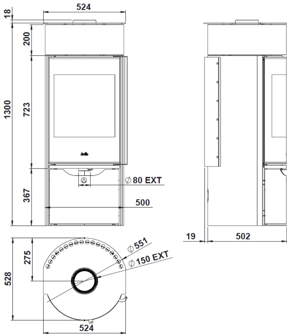
Figure n°3 - Dimensions en mm de l'appareil EGUZKI ACCUMULATEUR
