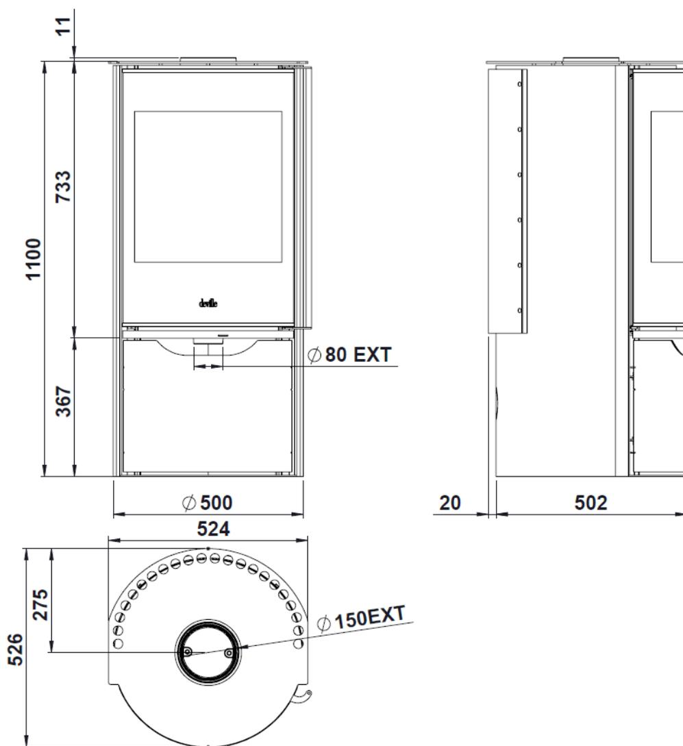
Figure n°1 - Dimensions en mm de l'appareil EGUZKI
