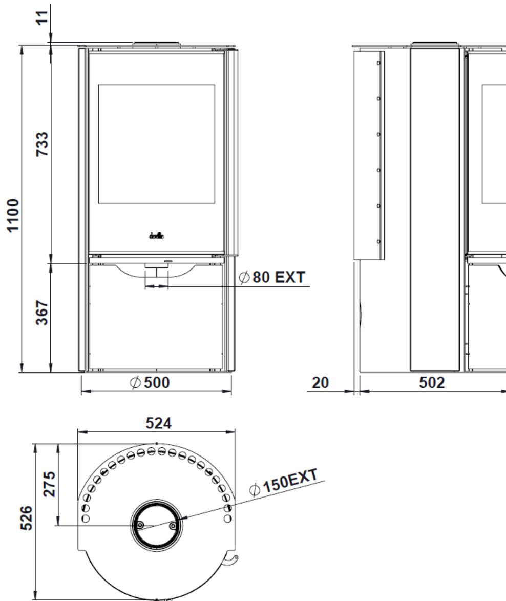
Figure n°4 - Dimensions en mm de l'appareil EGUZKI SERPENTINE
